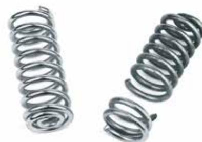
Fig. 1 Molla inutilizzata (sinistra) Molla vecchia e fratturata (destra).
