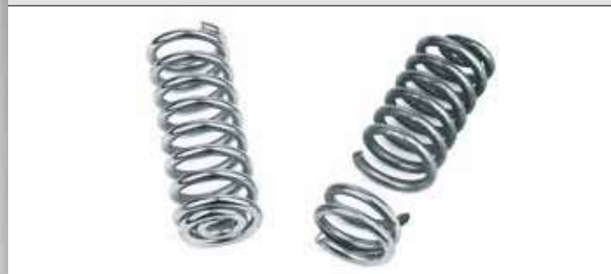
Fig. 1 Ressort inutilisé (à gauche). Ressort vieilli et cassé (à droite).
