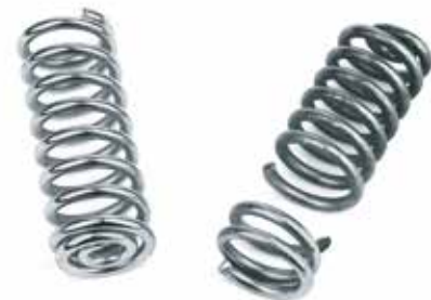
Abb. 1 Unbenutzte Feder (links). Gealterte und gebrochene Feder (rechts).
