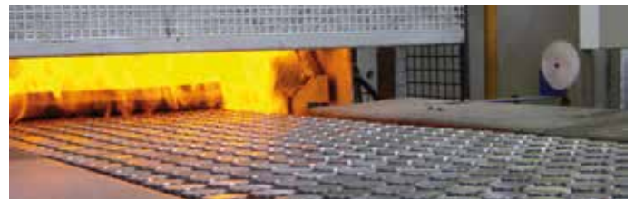
Exemple de pièces de série traitées en Trempe sous Atmosphère en four à tapis
