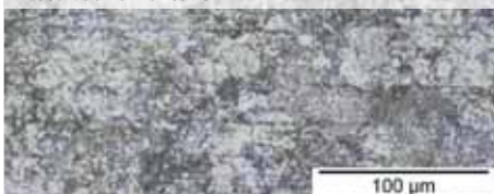
Acier C675 avec structure perlitique lamellaire après recuit de normalisation
