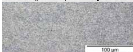
Acier C675 avec structure ferritique et carbures globulaires après recuit de globulisation
