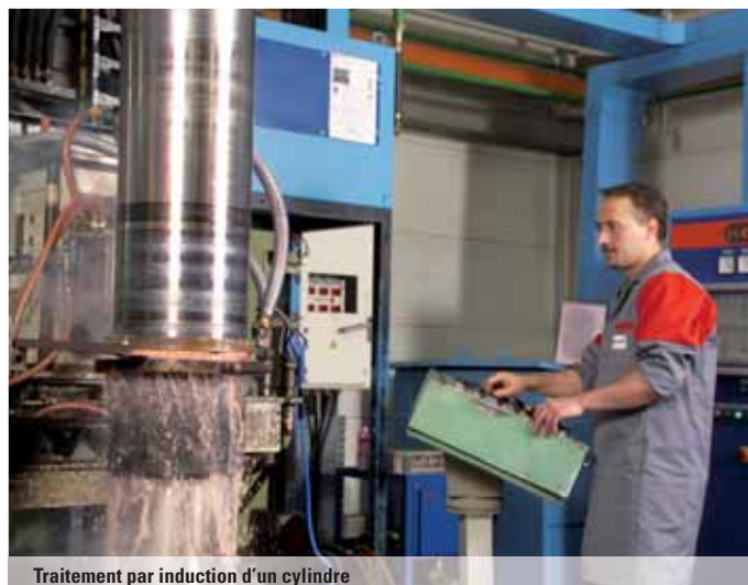
Traitement par induction d'un cylindre
