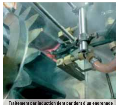
Traitement par induction dent par dent d'un engrenage
