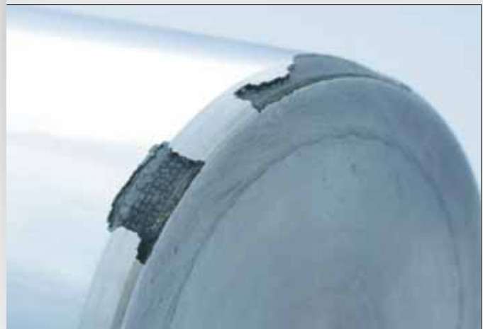
Abb. 2 Hartverchromter Zylinder mit Abplatzungen aufgrund dynamischer Belastung; dieses Problem existiert bei S 3 P-behandelten Stählen nicht.
