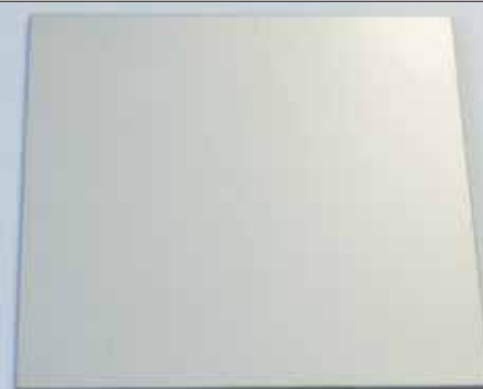
Fig. 2 Testad provbit; AISI 316L metallplåt (valsad 2B-yta) efter Kolsterising ® .
