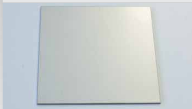
Fig. 2 Échantillon testé; feuille de métal AISI 316L (surface laminée 2B) après Kolsterising®.
