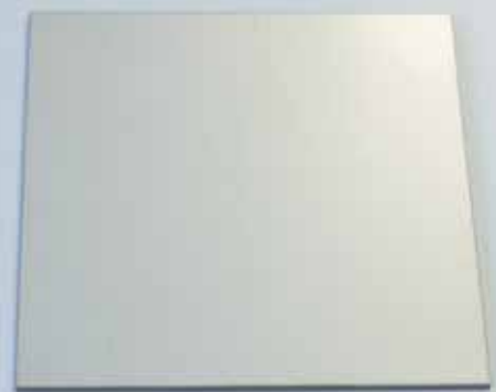
Abb. 2 Geprüfte Probe; AISI 316L-Blech (2B-Oberfläche) nach Kolstersieren®.
