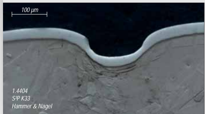
Abb. 2 Nach dem Hammer- & Nageltest von S 3 P-behandeltem AISI 316L sind in der stark deformierten Kohlenstoff S-Phase keine Rissbildungen erkennbar.
