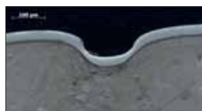
Dwarsdoorsnede van behandeld roestvast staal AISI 316L na snelle ernstige deformatie (hamer- en spijkertest)
