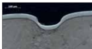
Coupe transversale d'acier inoxydable AISI 316L traité, après déformation à charge lourde et rapide (test marteau et clou)
