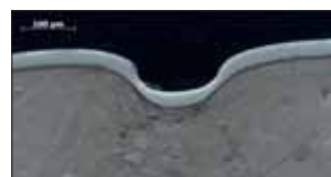
Querschnitt eines behandelten rostfreien Stahls AISI 316L nach schneller starker Verformung (Hammer- und Nageltest)
