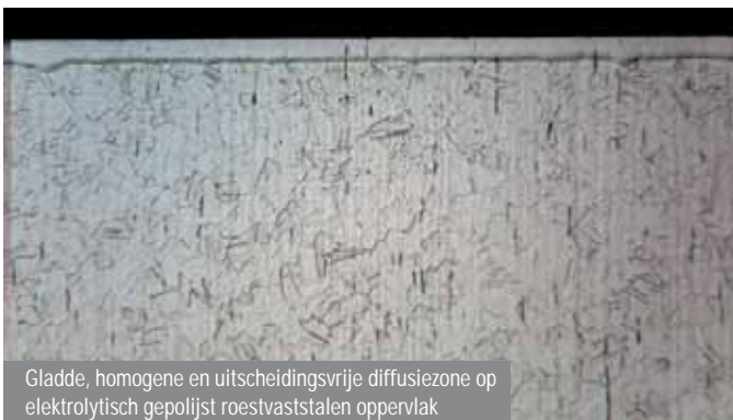
Fig. 3: Vergelijking van LTSH-resultaten voor AISI 316L na elektrolytisch polijsten (links) en zandstralen (rechts). Zandstralen leidt tot plaatselijke grote deformaties met overmatige vorming van deformatiemartensiet. Diffusie wordt verhinderd en de corrosiebestendigheid verlaagd. De elektrolytisch gepolijste oppervlakken leiden tot een foutloze en homogene diffusiezone.
