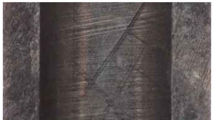
Fig. 4: Gehoond oppervlak van roestvast staal. Rechts: hoge snijkrachten en versleten gereedschap leiden tot een oppervlak dat eerder vervormd dan gesneden is. Links: lage krachten en scherp gereedschap zorgen voor een duidelijk slijppatroon, wat typerend is voor normale honen-behandelingen. Minder deformatie, warmte-invoer en 'smeren' leidt tot beter diffusiegedrag en verbeterde corrosiebestendigheid.
