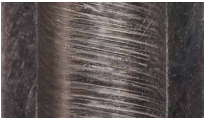
Fig. 4: Gehoond oppervlak van roestvast staal. Rechts: hoge snijkrachten en versleten gereedschap leiden tot een oppervlak dat eerder vervormd dan gesneden is. Links: lage krachten en scherp gereedschap zorgen voor een duidelijk slijppatroon, wat typerend is voor normale honen-behandelingen. Minder deformatie, warmte-invoer en 'smeren' leidt tot beter diffusiegedrag en verbeterde corrosiebestendigheid.
