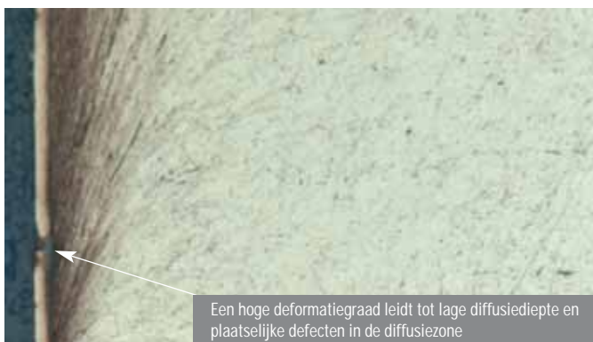
Fig. 5: Oppervlaktegehard roestvaststalen component. Links: Geponst oppervlak. Onregelmatig en ernstig vervormd (donkere gebieden) oppervlak. Verminderde diffusiediepte en verzwakte corrosie-eigenschappen in deze zone. Rechts: hetzelfde onderdeel doorboord in plaats van gestanst. Minder deformatie en gelijkmatige oppervlaktekwaliteit leiden tot hogere diffusiediepte en verbeterde corrosie-eigenschappen.
