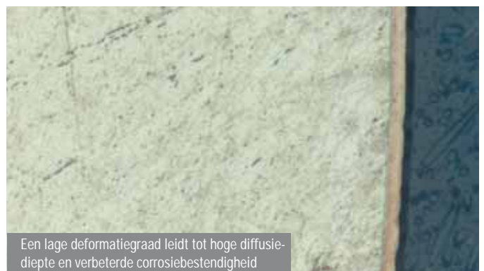
Fig. 5: Oppervlaktegehard roestvaststalen component. Links: Geponst oppervlak. Onregelmatig en ernstig vervormd (donkere gebieden) oppervlak. Verminderde diffusiediepte en verzwakte corrosie-eigenschappen in deze zone. Rechts: hetzelfde onderdeel doorboord in plaats van gestanst. Minder deformatie en gelijkmatige oppervlaktekwaliteit leiden tot hogere diffusiediepte en verbeterde corrosie-eigenschappen.
