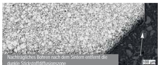
Abb. 6: Querschnitt gesintertter MIM-Teile aus Edelstahl. Die Stickstoffdiffusion (dunkle Oberfläche) verhindert eine ungehinderte Diffusion und hohe Oberflächenhärte nach NTOH. Ein nachfolgender Bohrvorgang (rechts) entfernt die Stickstoffdiffusionszone teilweise. In diesem Bereich ist eine ungehinderte Diffusion möglich.
