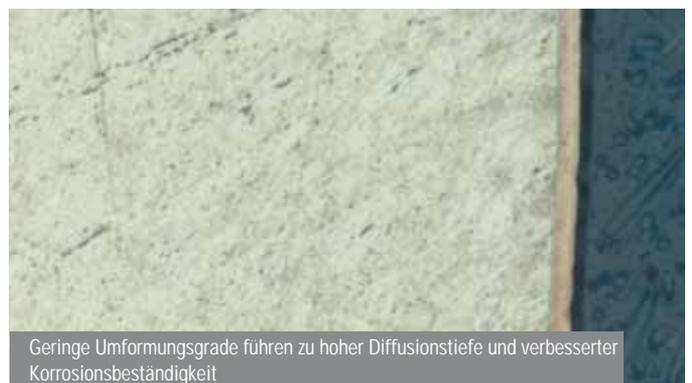
Abb. 5: Oberflächengehärtetes Edelstahlbauteil. Links: Gestanzte Oberfläche. Unregelmäßige und stark verformte (dunkle Bereiche) Oberflächen. Geringere Diffusionstiefe und beeinträchtigte Korrosionseigenschaften in dieser Zone. Rechts: gleiches Teil gebohrt statt gestanzt. Weniger Verformung und gleichmäßige Oberflächenbeschaffenheit führen zu einer höheren Diffusionstiefe und verbesserten Korrosionseigenschaften.
