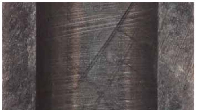
Abb. 4: Geschliffene Edelstahloberfläche. Rechts: Hohe Schnittkräfte und ein verschlissenes Werkzeug führen zu einer Oberfläche, die eher umgeformt als geschnitten ist. Links: Geringe Kräfte und scharfes Werkzeug führen zu einem ausgeprägten Schleifbild, was für die korrekte Honbearbeitung selbstverständlich ist. Weniger Umformung, Wärmeeintrag und Schmierung führen zu einem besseren Diffusionsverhalten und verbesserter Korrosionsbeständigkeit.
