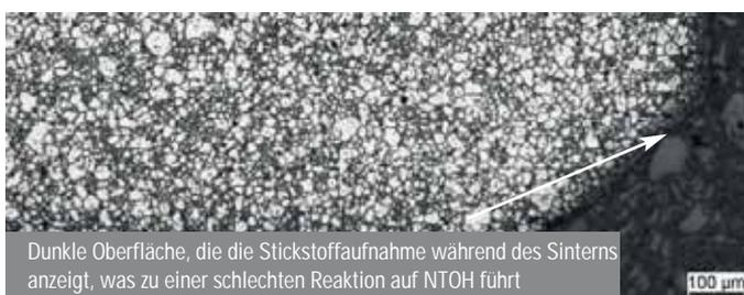
Abb. 6 zeigt ein Sinterteil mit einer beeinflussten Oberfläche durch Stickstoffdiffusion in einer  $H_2/N_2$ -Atmosphäre. Ein anschließender Bohrvorgang (rechtes Bild) entfernte die betroffene Oberfläche. In diesem Bereich ist eine ungehinderte Diffusion möglich.
