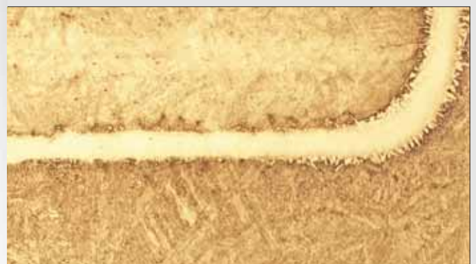
Twee voorbeelden van gehard staal gesoldeerd met Ni-soldeer.
