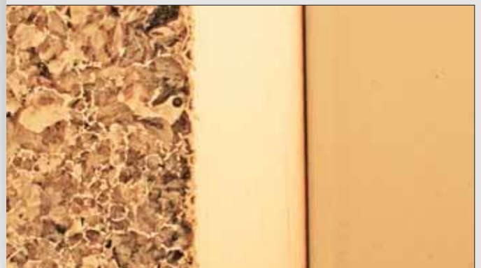
Hartmetall auf Vergütungsstahl mit Cu gelötet.
