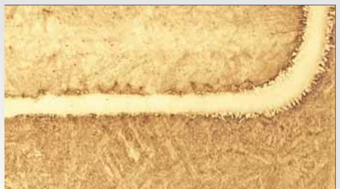
Zwei Proben aus Vergütungsstahl mit Ni-Lot verlötet.
