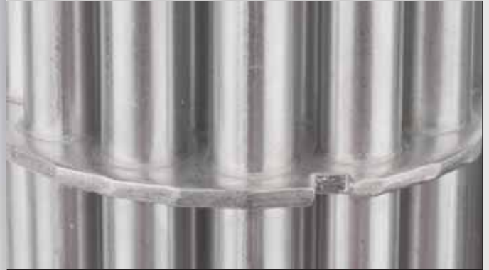
In einem Lötzyklus können viele Fügstellen auch an schlecht zugänglichen Stellen gleichzeitig gelötet werden.
