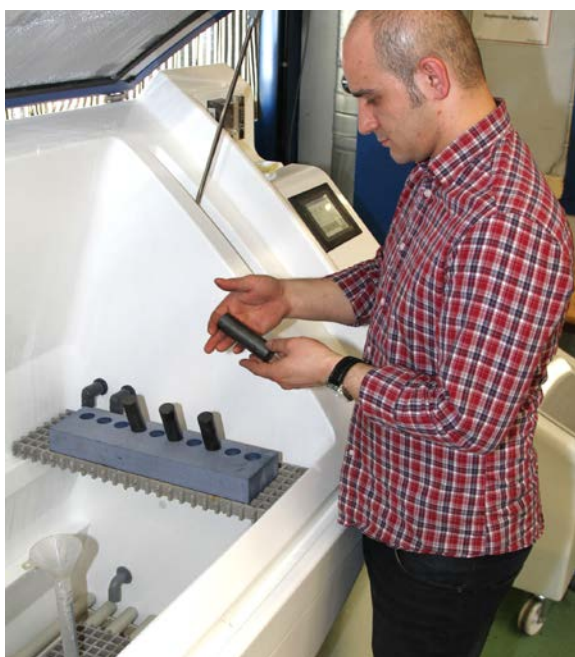
Ny investering. Saltdimkammaren är tagen i bruk och säkerställer att kvaliteten på kundens detaljer är optimala. Samtidigt är den en viktig bricka i utvecklingen av nya och förbättrade processer från Bodycote.
