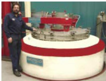
Gasnitring er en lavtemperaturproces, der typisk udføres ved ca. 500-530° C. Gasnitring bibringer stålemner mange fordele som f.eks. hård overflade, forbedret udmattelses- og trykstyrke. Dette kombineret med excellent dimensionsstabilitet og høj anløbningsbestandighed gør processen bredt anvendelig.
