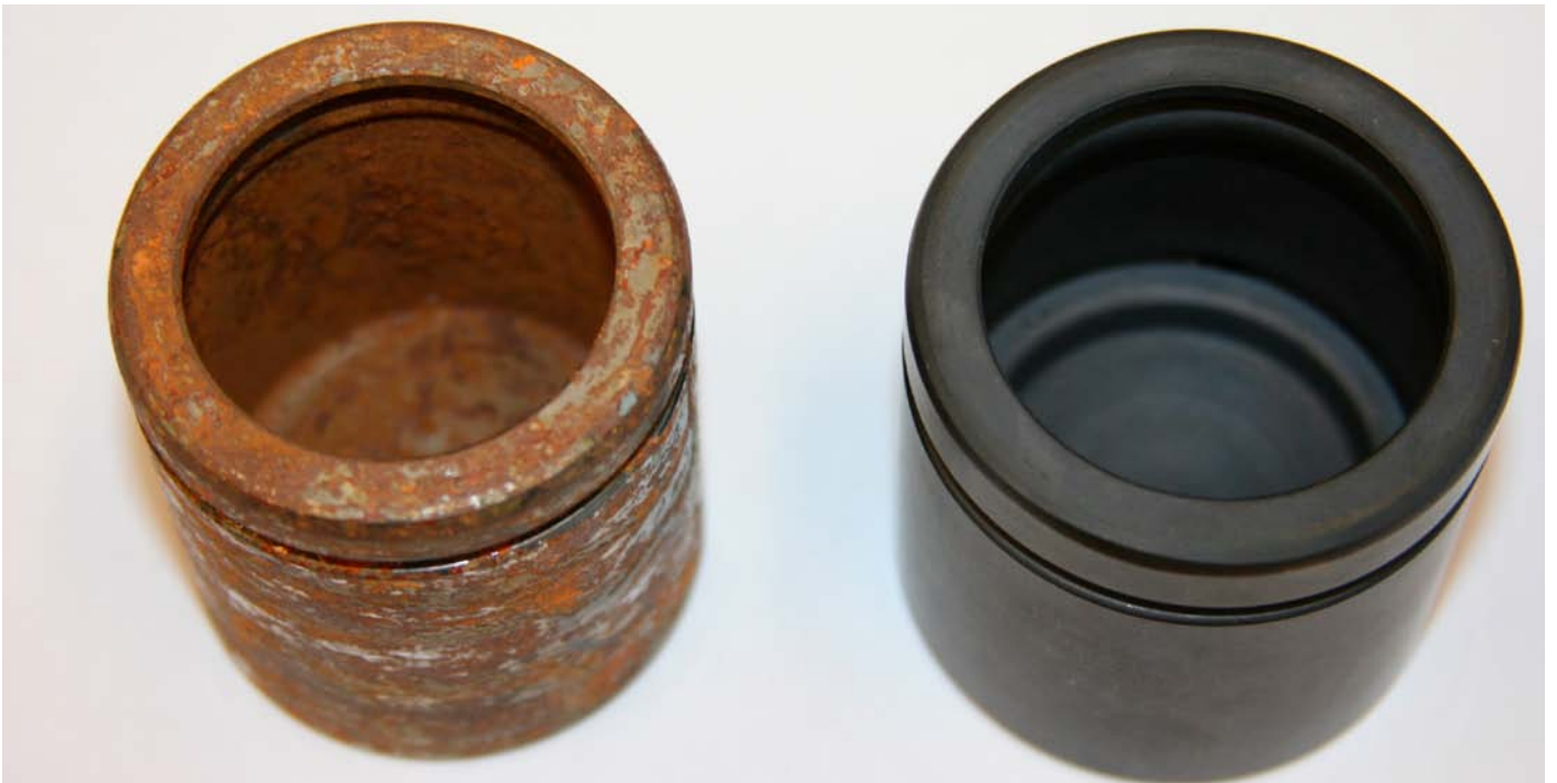
Kuva yllä: Jarrumännät NSS korroosiokekeessa, vasen kovakromattu, oikea Corr-I-Dur -käsitelty.
