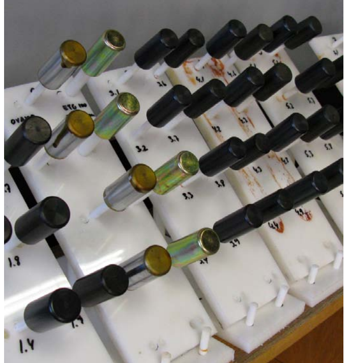
Kuva yllä: Kappaleita korroosiokekeessa.
