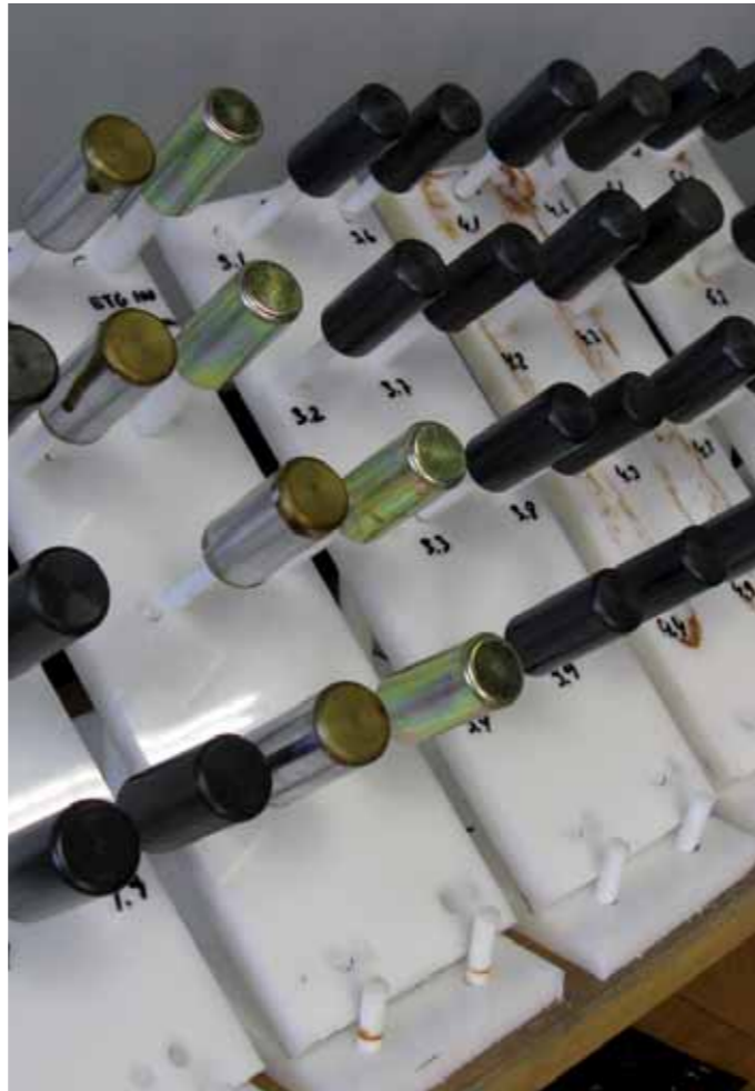
Rack mit Teststücken für die Korrosionstests
